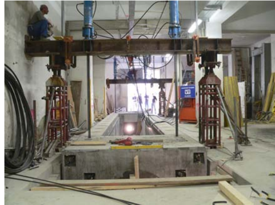
Abbildung 2: Untersicht des Prüfrahmens und Federelemente als Auflager für eine schwingungsisolierende Lagerung (rechts); Prüfrahmen während des Absenkens (links).
