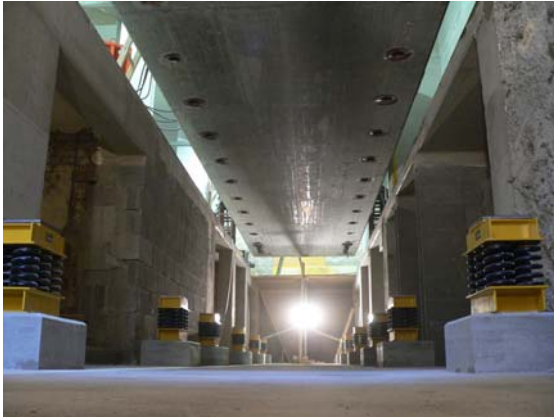
Abbildung 2: Untersicht des Prüfrahmens und Federelemente als Auflager für eine schwingungsisolierende Lagerung (rechts); Prüfrahmen während des Absenkens (links).
